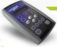
Telecomando a radiofrequenza per la gestione simultanea di quattro navette satellitari, dotato di display grafico e supporto multilingue. Gestione del controllo automatico e manuale, della diagnostica degli allarmi e dello stato delle batterie.
